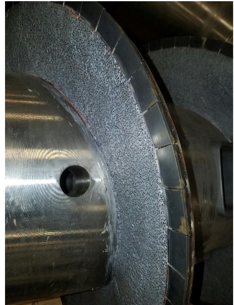
Блок из карбида вольфрама + керамический клей
